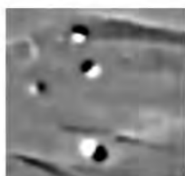
Isolierte Eisenteile nahe Oberfläche mit charakterist. Dipolanomalie (Dynamik -/+50 nT, Bildbreite 5 m)
