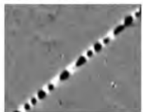
Wasserleitungsrohr aus Eisen (Dynamik -/+50 nT), Bildbreite 30 m
