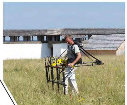
Vier-Kanal-Gradiometer FEREX bei der Messung
