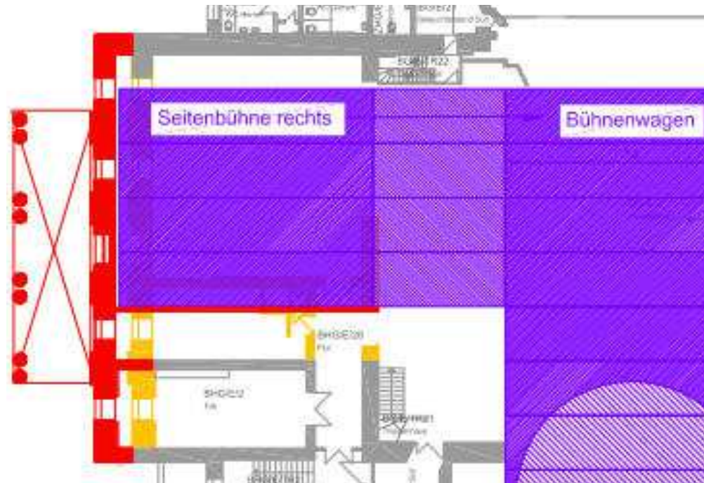
Abb. C.2_4 Drausicht Opernhaus mit erweiterter Seitenbühne rechts (gelb: Abbruch alte Konstruktion, rot: neue Konstruktion)
