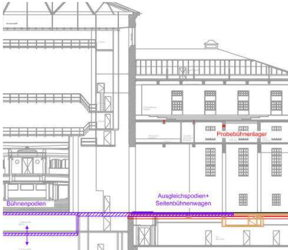
Abb. C.2_5 Querschnitt Opentheater mit Seitenbühne links (Blick Richtung Zuschauerraum), (gelb: Abbruch alte Konstruktion, rot: neue Konstruktion)
