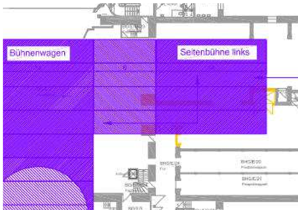
Abb. C.2_6 Draufsicht Opentheater mit erweiterter Seitenbühne links (gelb: Abbruch alte Konstruktion)
