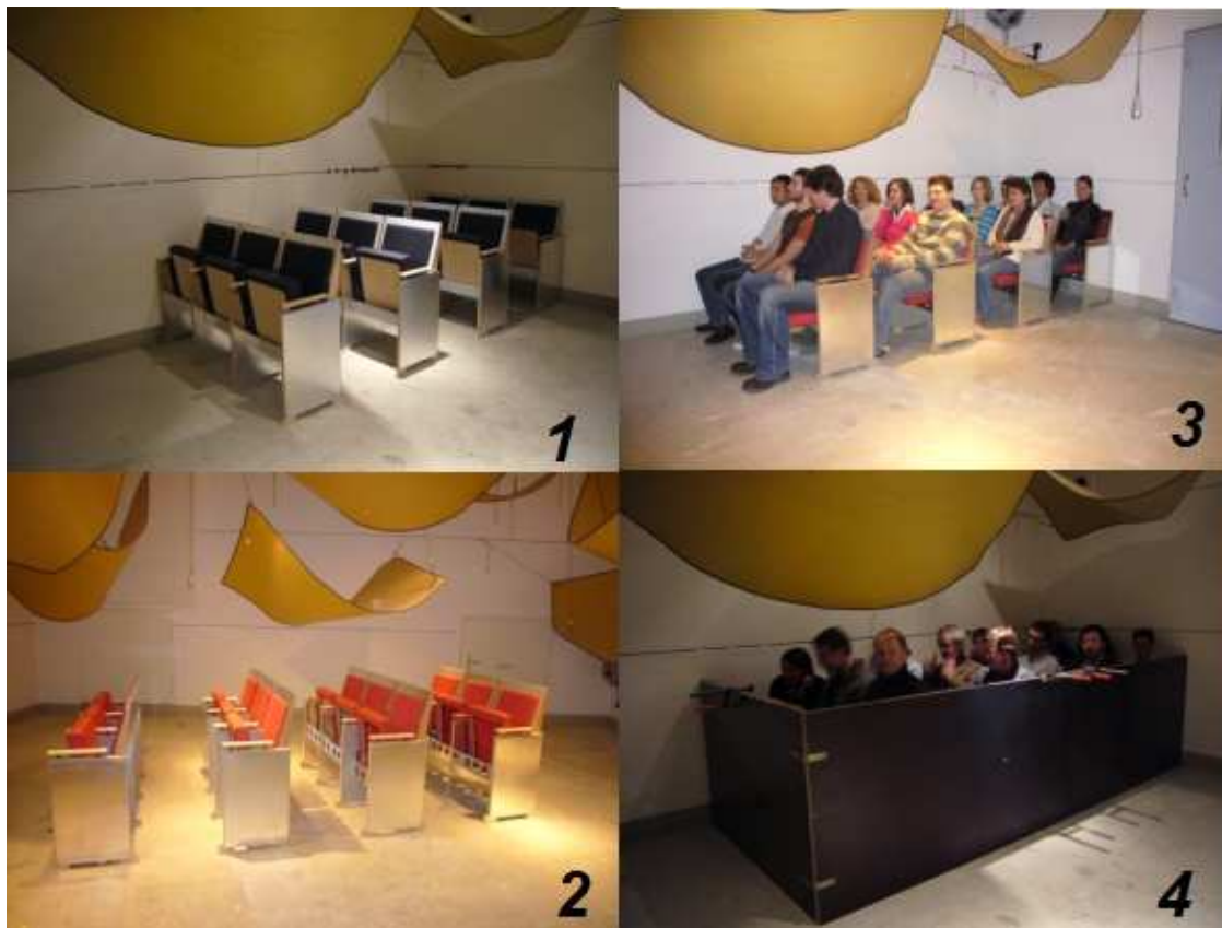
Abb. C.5_4. Messung des frequenzabhängigen Schallabsorptionsgrades der Saalbestuhlung im Hallraum gemäß DIN EN ISO 354 für folgende Varianten:
